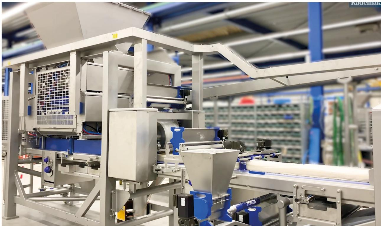
**L** innovativo sistema di Rademaker Double Chunker Sheeting System (DSS) è progettato per lavorare l'impasto fortemente idratato con lunghi tempi di pre-fermentazione.
